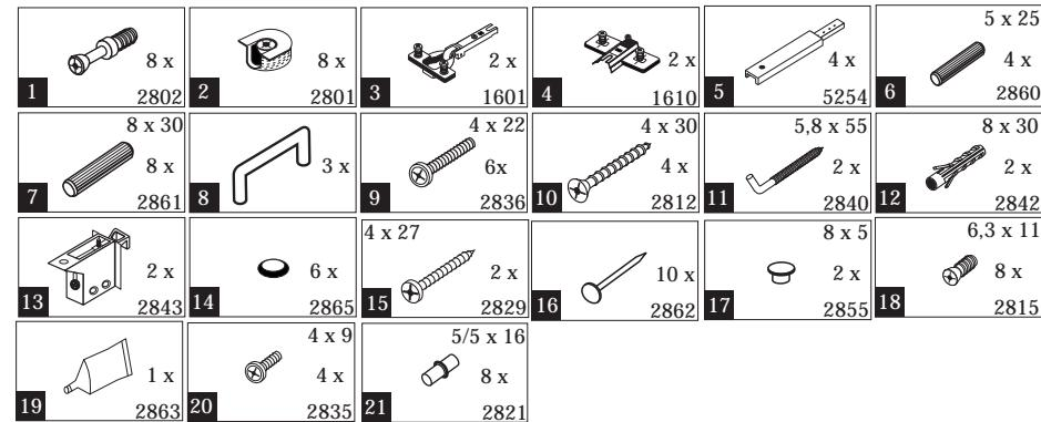
Das beigelegte Wandbefestigungsmaterial (Dübel und Schrauben) eignet sich nur für festes Mauerwerk (z.B.: Beton- oder Ziegelwände). Für andere Wandaufbauten sind eventuell Spezialdübel und andere Schrauben notwendig. Ziehen Sie gegebenenfalls eine Fachkraft zu Rate.
